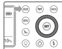
1 <MODE> 発光モード選択ボタンを押すと、ディスプレイに <MULTI> を表示させます。
