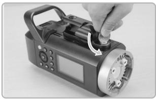
1 相応する六角棒レンチを使って、ホルダーフィットねじに差し込み、反時計回りに緩めると、ホルダーを取り外すことができます。
